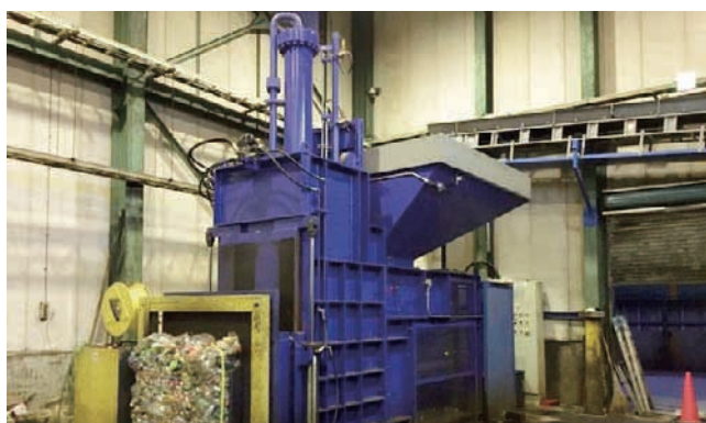
ペットボトルの大型圧縮機
