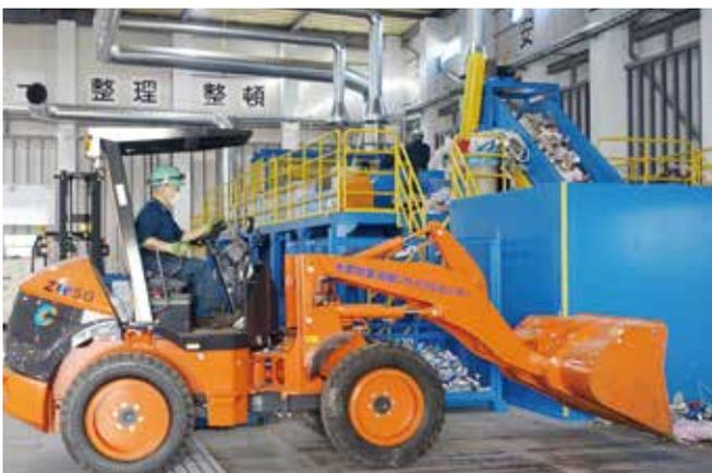
受け入れた資源物を、重機を用いてコンベアに押し流します
