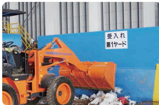
重機を用いて、不燃ごみをコンベアに流します
