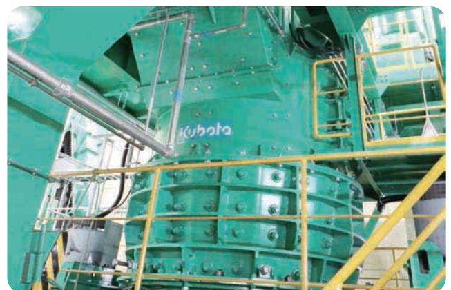
縦型破碎機。中央の円柱部分で粗大ごみを破碎しています。
